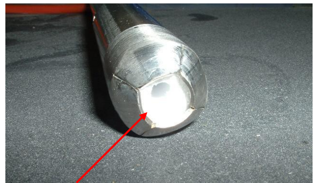
Styroporkappe als Transportsicherung, verbrennt bei Erstzündung
